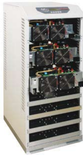
USV Elektronik (modularer Aufbau / Powermodule)
